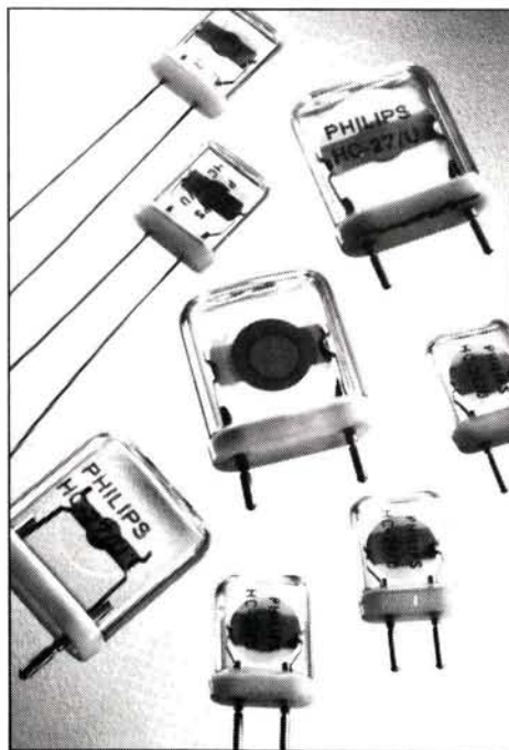
Figure 1 – Les quartz de nos appareils sont plus souvent enfermés dans des boîtiers métalliques. On en trouve, comme ici, dans des enceintes de verre qui permettent de les voir par transparence.
