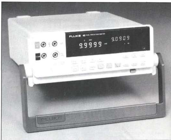
Il n'est pas exceptionnel de trouver des appareils à double affichage, l'un numérique, l'autre analogique, notamment dans la catégorie des multimètres. Le modèle récent ci-dessus appartient au haut de la gamme d'un constructeur réputé; la présence d'un deuxième afficheur numérique facilite par exemple la comparaison de deux mesures successives.
